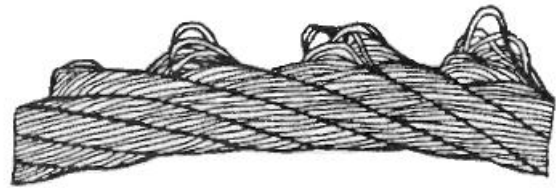
Рис. 9.5. Видавлювання дротів сталок: a – в одній сталці; б – у декількох сталках
